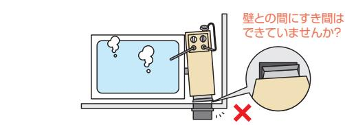
ガスをふたたび使用するときは、ガス機器周辺でガスの臭いがしないか、ガス機器本体に変形・破損など異常がないか、また煙突式など屋内外の給排気設備に、外れ・凹み・閉塞がないか確認してください。
