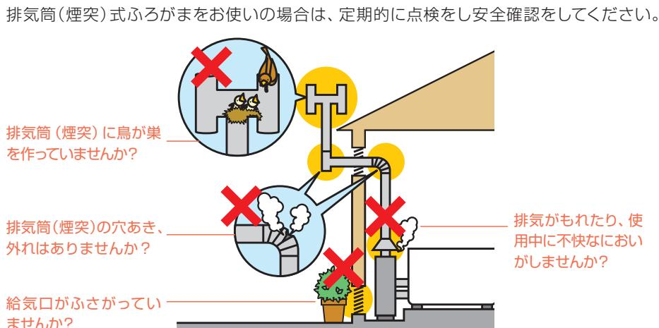
●屋内にあるふろがまや湯沸器などには、法令により適正な給排気設備の設置が義務付けられています。給排気設備に不備があると一酸化炭素中毒事故を起こすおそれがあり、大変危険です。
